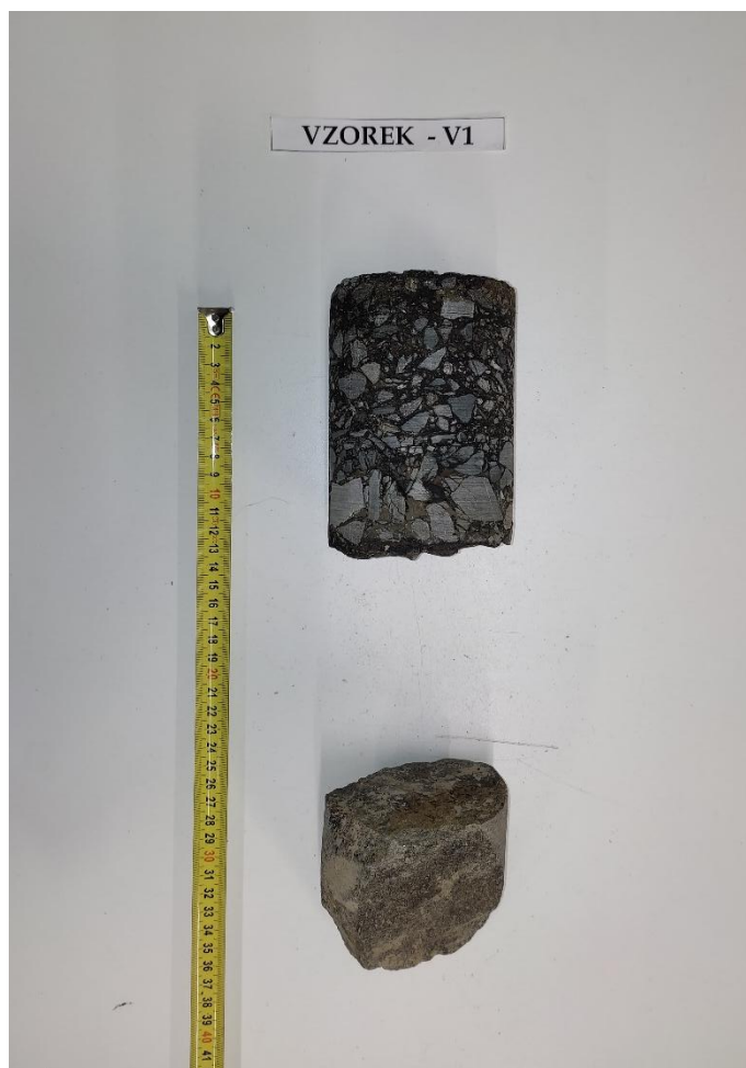
Obr. 2 - Jádru vývrtu Vzorek – V1 (laboratoř).
