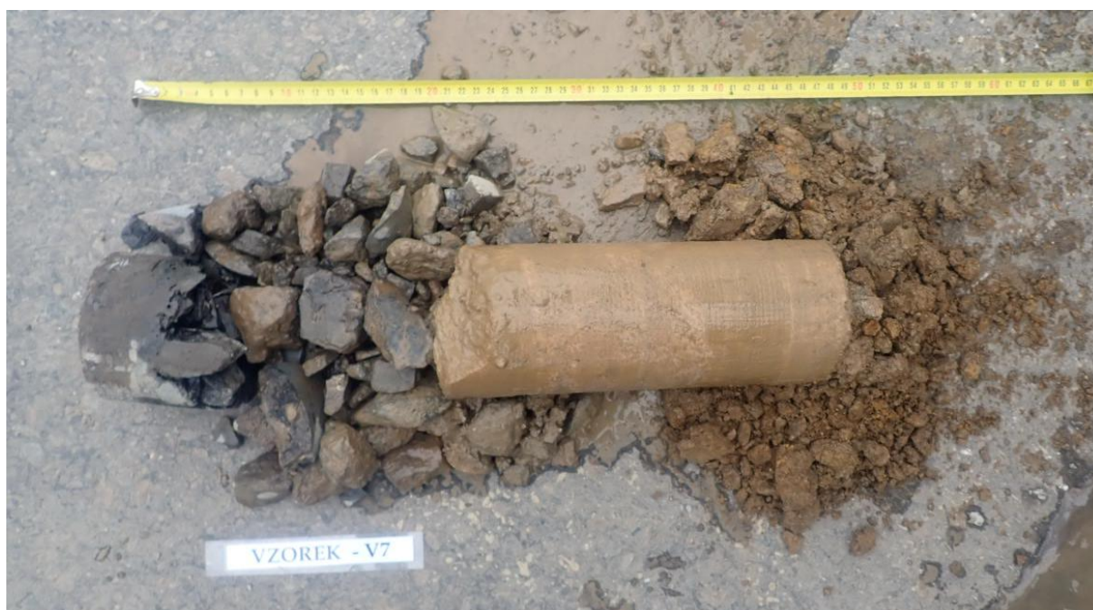
Obr. 13 - Jádru vývrtu Vzorek – V7 (in situ).
