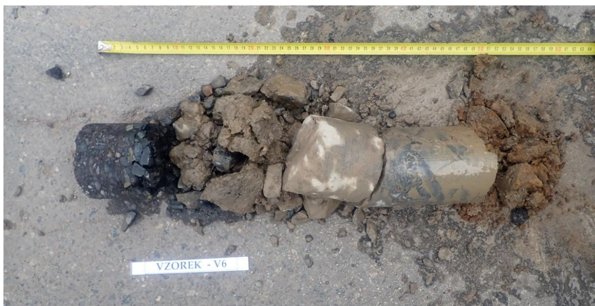
Obr. 11 - Jádro vývrtu Vzorek – V6 (in situ).
