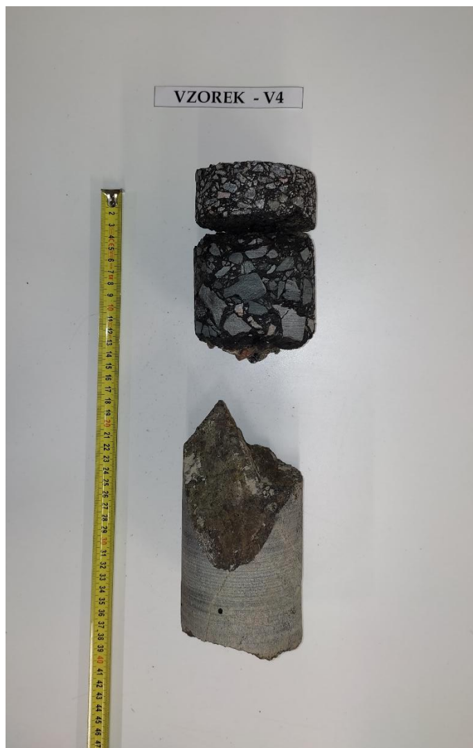
Obr. 8 - Jádru vývrtu Vzorek – V4 (laboratoř).
