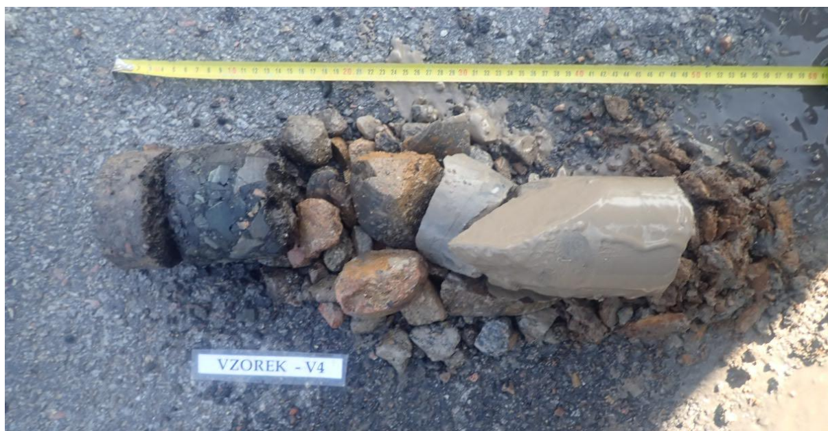
Obr. 7 - Jádro vývrtu Vzorek – V4 (in situ).
