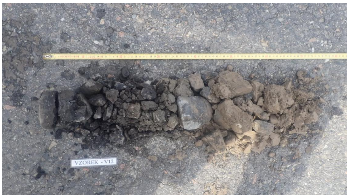
Obr. 23 - Jádro vývrtu Vzorek – V12 (in situ).
