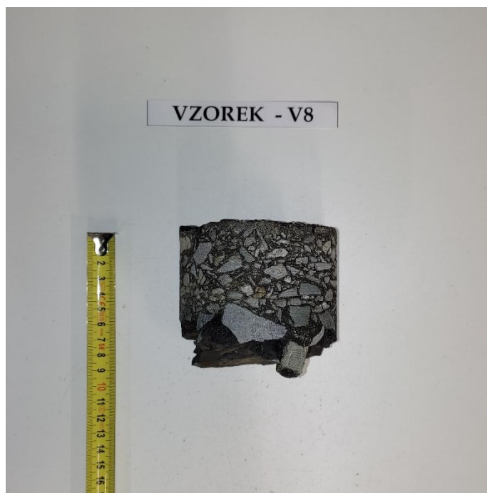
Obr. 16 - Jádru vývrtu Vzorek – V8 (laboratoř).
