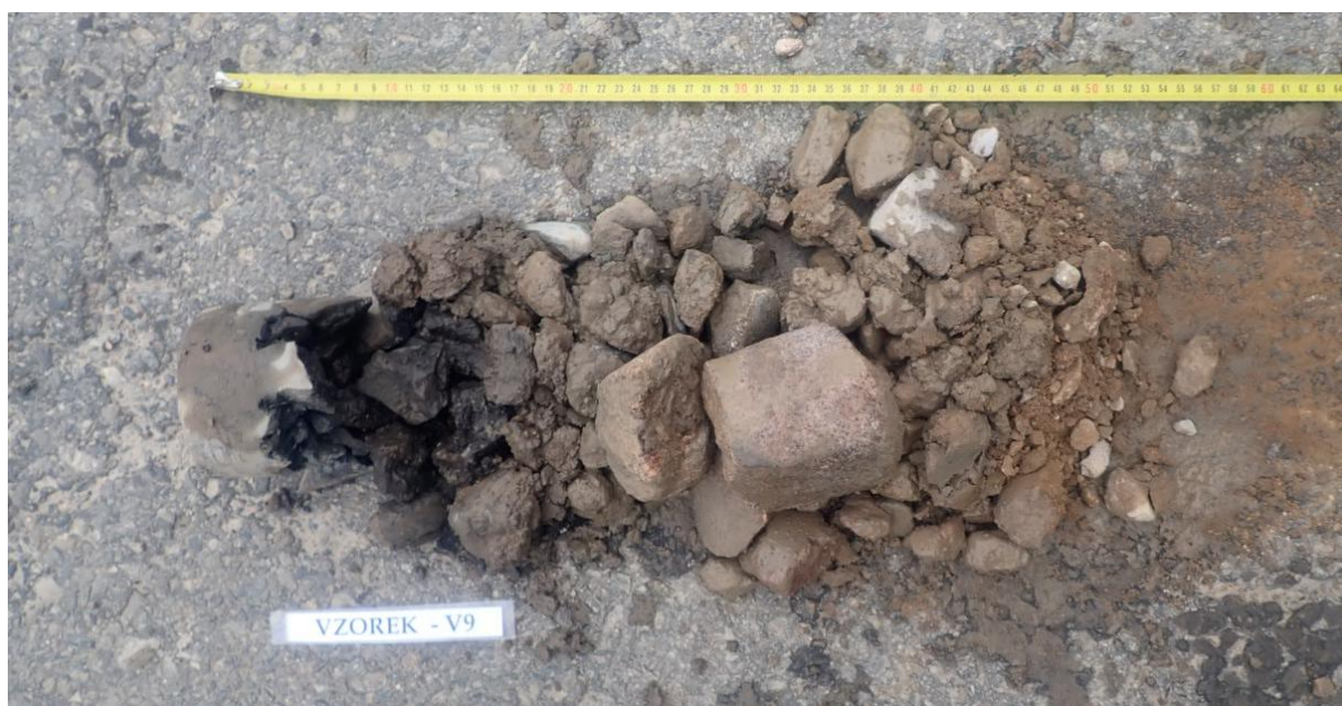
Obr. 17 - Jádro vývrtu Vzorek – V9 (in situ).
