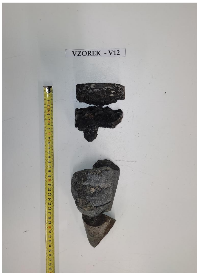
Obr. 24 - Jádru vývrtu Vzorek – V12 (laboratoř).
