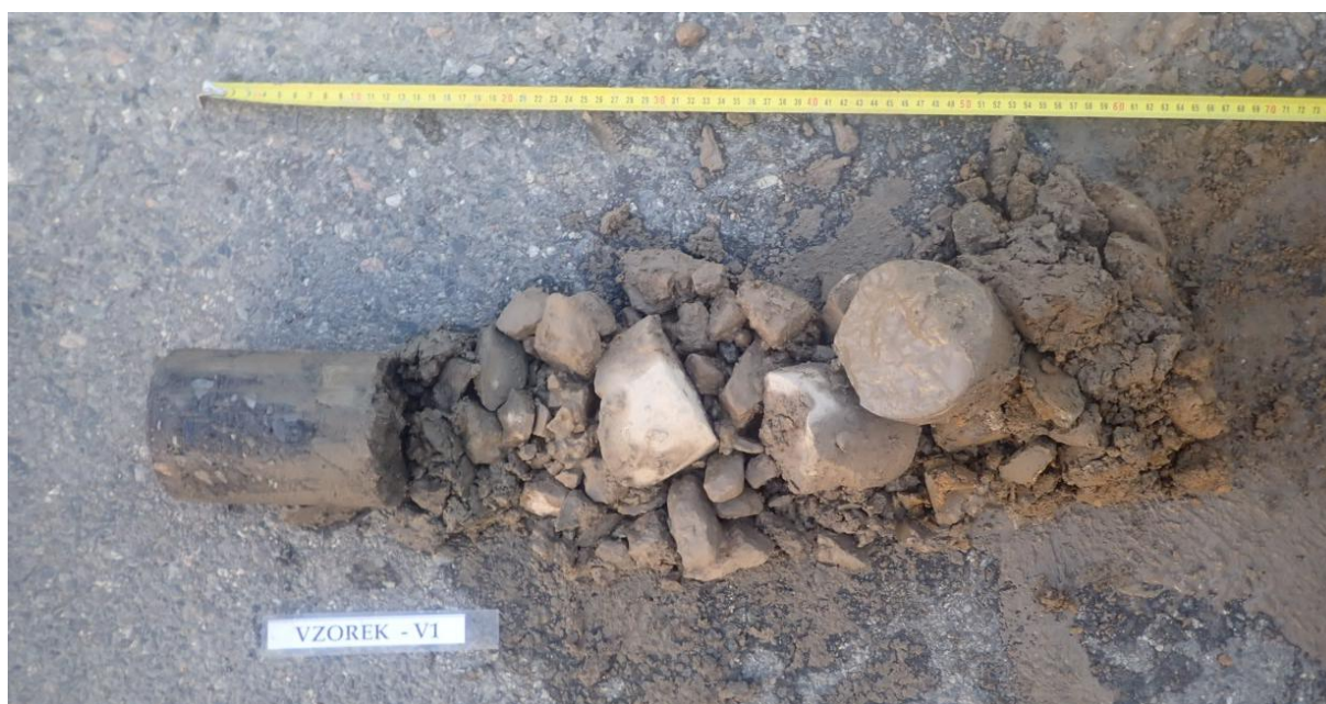
Obr. 1 - Jádro výtvtu Vzorek – V1 (in situ).
