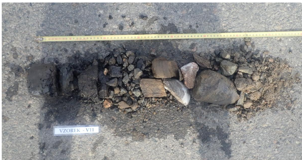
Obr. 21 - Jádro vývrtu Vzorek – V11 (in situ).
