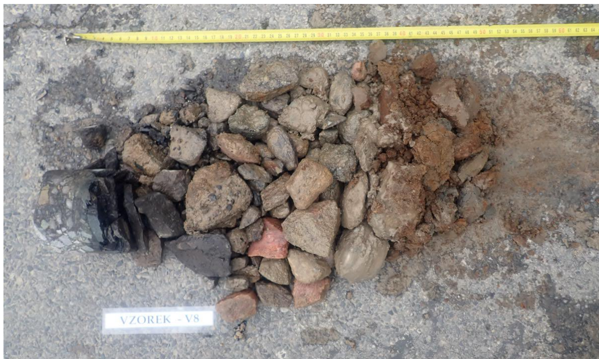
Obr. 15 - Jádru vývrtu Vzorek – V8 (in situ).
