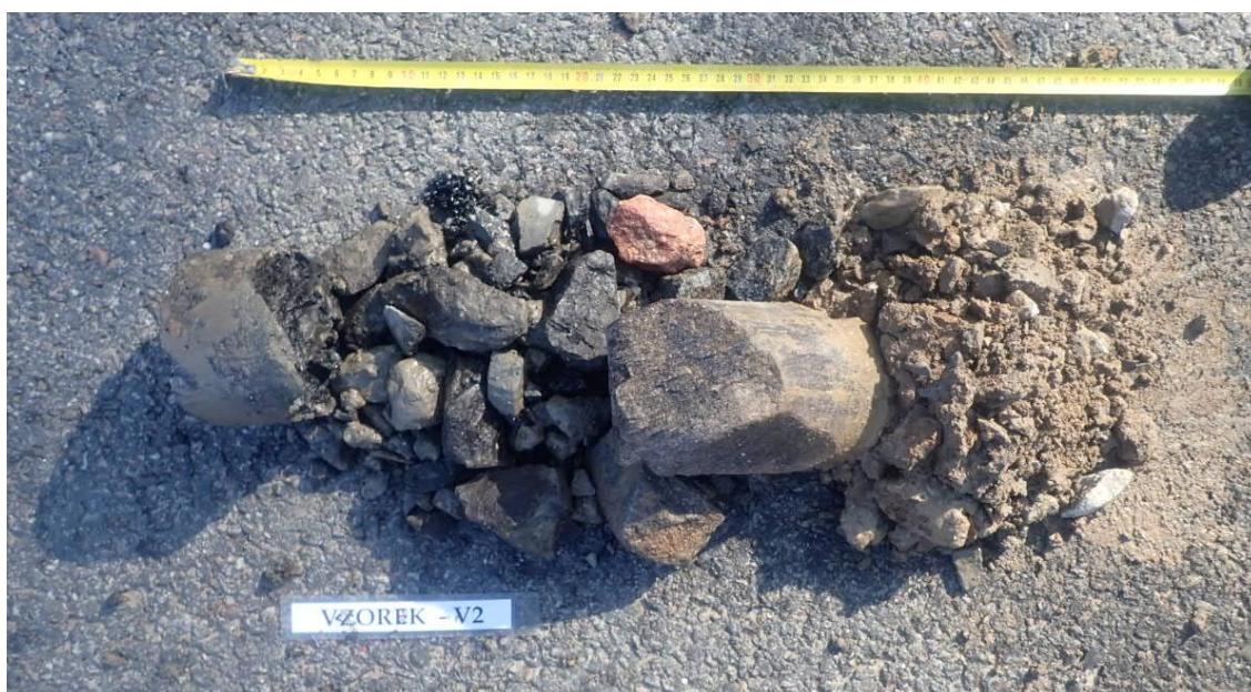
Obr. 3 - Jádro vývrtu Vzorek – V2 (in situ).
